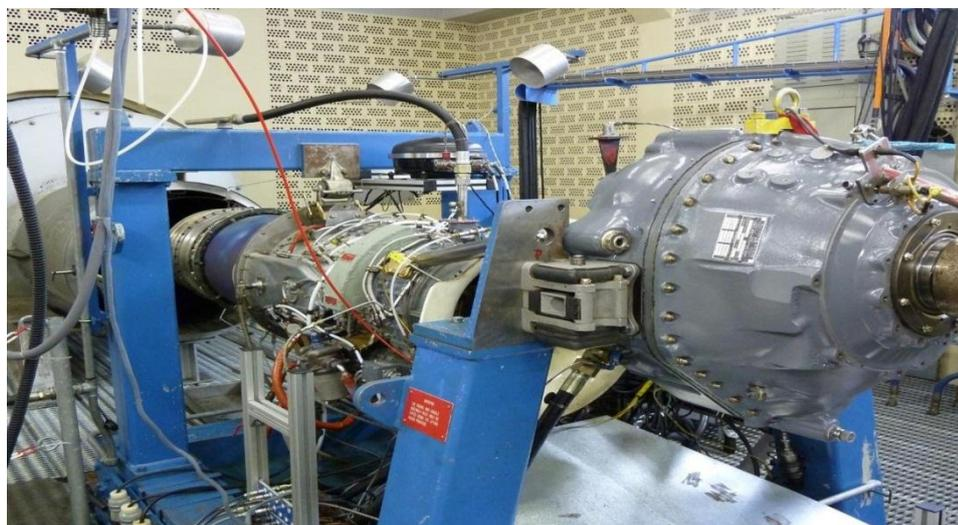
Le banc d'essai numéro 4 de l'Atelier Industriel de l'Aéronautique (AIA) de Bordeaux permet de réaliser des essais sur des turbomoteurs, ainsi que sur un groupe auxiliaire de puissance. Le banc ayant une quinzaine d'années, l'AIA a souhaité rénover le système d'acquisition de données, de contrôle/commande et de supervision, et y intégrer de nouvelles fonctionnalités. Il a, pour cela, fait appel aux services d'ingénierie de la société Nerys.
